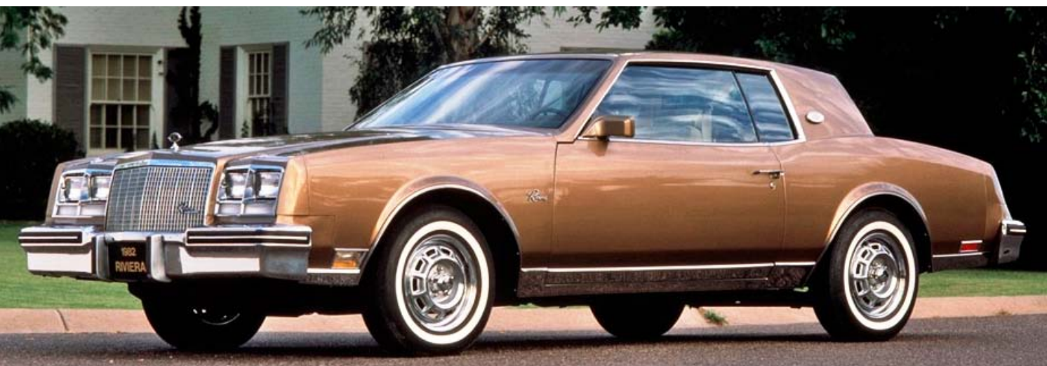
Der Buick Riviera lief vom gleichen Band in Linden, New Jersey wie der Eldorado und bot sowohl technisch mit einem 3,8-Liter-Turbo-V6 als auch stilistisch mit seiner schwülstig-geschwungenen Linienführung eine Alternative.
